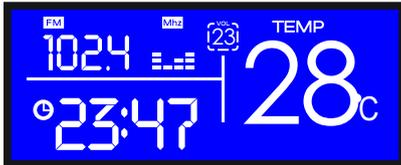
Нажмите кнопку (4), чтобы включить функцию воспроизведения музыки Радио. В верхней части экрана отобразится значок диапазона FM и частота. Чтобы настроить частоту требуемой станции нажмите кнопку (3) 2 раза, пока цифры частоты не начнут мигать. Произведите настройку кнопками (1) и (2). Система сохранит настройки, когда цифры перестанут мигать.
